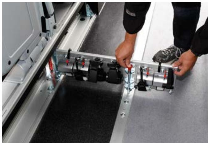
■ Einfache Entriegelung der Tragarme mit einem Handgriff
