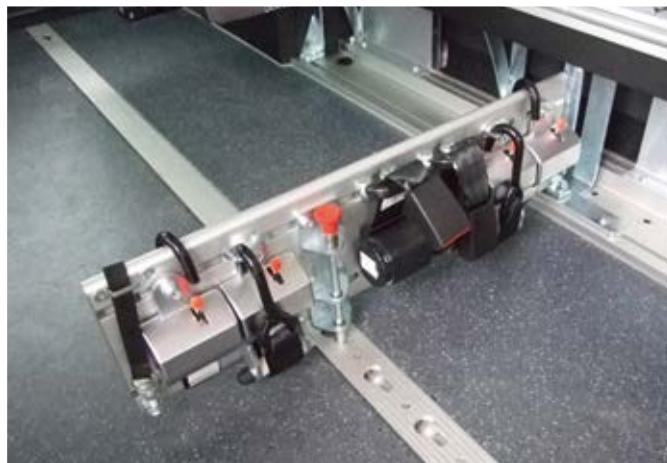
■ Diverse Einrastpositionen und verschiebbare Tragarme ermöglichen die sichere Befestigung kurzer oder langer Rollstühle
