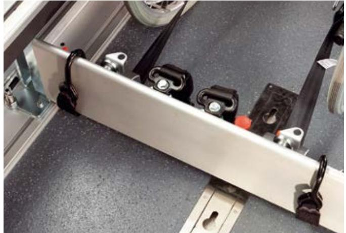
■ Hintere Rollstuhlverspannung: Alle Rückhaltesysteme verwechslungssicher am richtigen Ort
