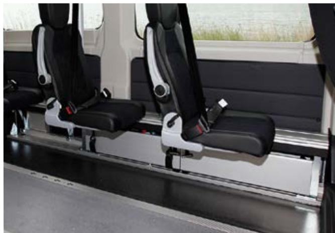
■ Einsatzbereite Rollstuhl-Rückhaltesysteme in der Seitenwand, geschützt vor Schmutz und Beschädigung
