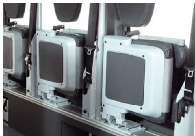
■ Sitze hochgeklappt optimal an der Seitenwand verstaut
