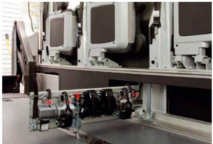
■ Alles am mittleren Tragarm: Hintere Verspannung und Beckengurt für den vorderen Rollstuhl, vordere Verspannung für den hinteren Rollstuhl
