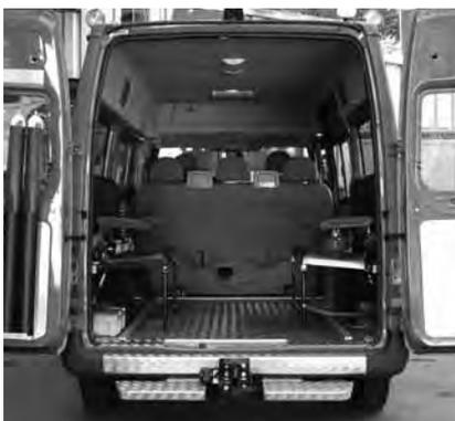
Véhicule de transport d'équipe avec banquettes longitudinales
