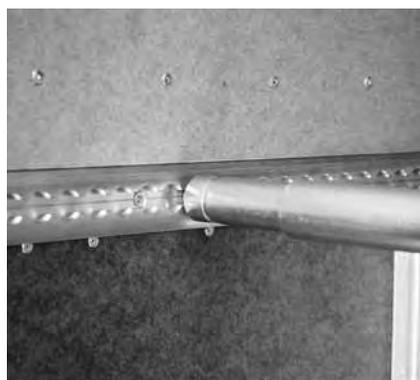
Sangle d'arrimage Airline avec barre de blocage télescopique
