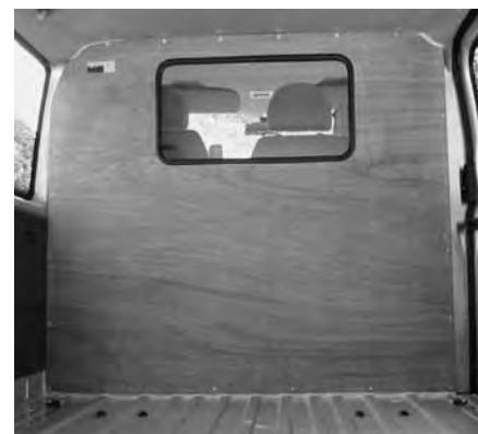
Paroi de séparation type C avec fenêtre
