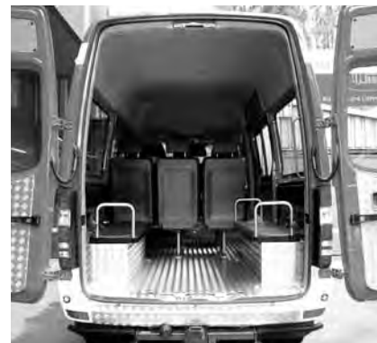
Véhicule de transport d'équipe avec banquettes longitudinales
