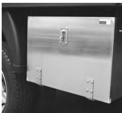
Boîte à outils sous le pont
