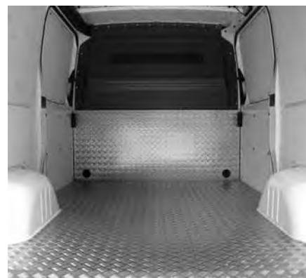
Renforcement de la paroi de séparation
