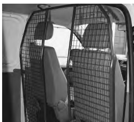
Paroi de séparation B avec passage
