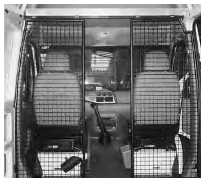
Paroi de séparation type B avec passage
