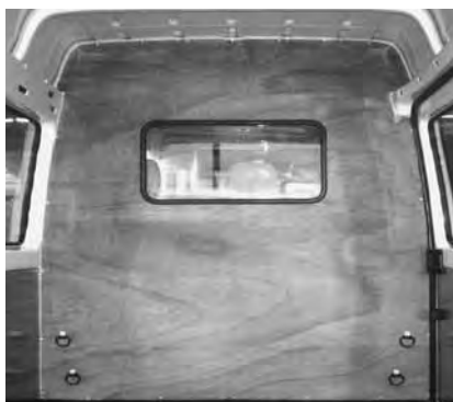
Paroi de séparation type C avec fenêtre
