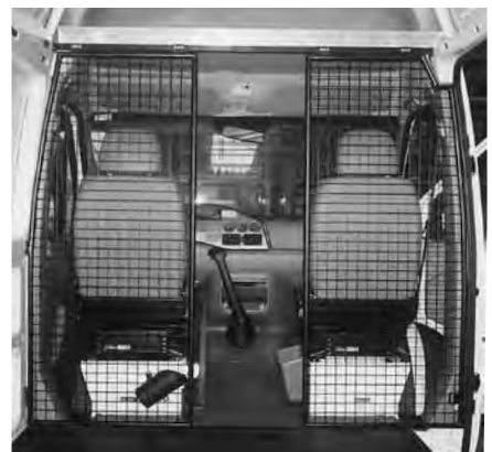
Paroi de séparation B avec passage
