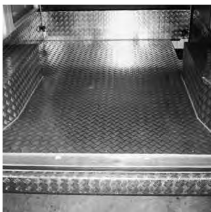
Revêtements tout autour | Passage de roue spécial | Seuil de porte à l'arrière au lieu d'un élément plastique | Pare-chocs renforcé
