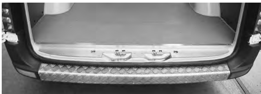
Seuil de porte à l'arrière au lieu d'un élément plastique et pare-chocs renforcé
