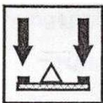
Insérer des cales (Ex. Liège), Hauteur minimale du cordon de colle 2 – 3 mm.
