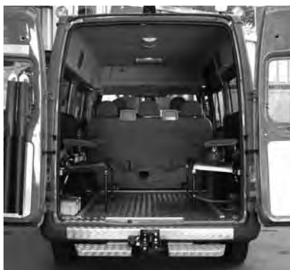
Véhicule de transport d'équipe avec banquettes longitudinales
