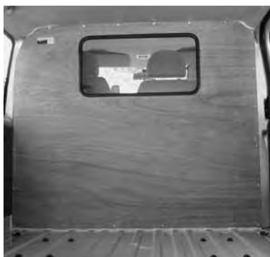
Paroi de séparation type C avec fenêtre
