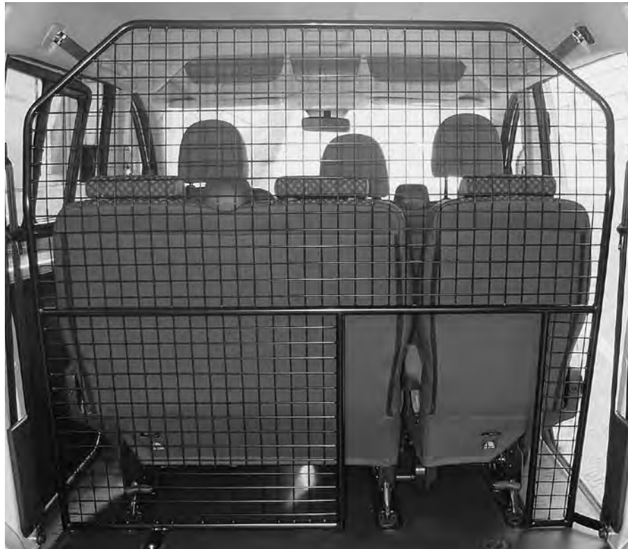
Exécution spéciale avec passage pour matériel
