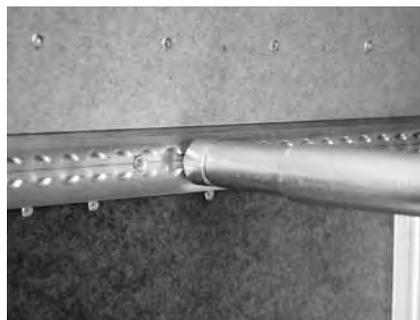
Sangle d'arrimage Airline avec barre de blocage télescopique
