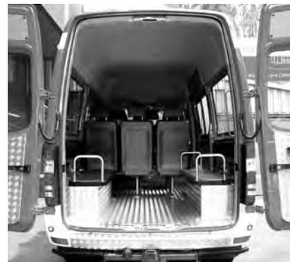
Véhicule de transport d'équipe avec banquettes longitudinales
