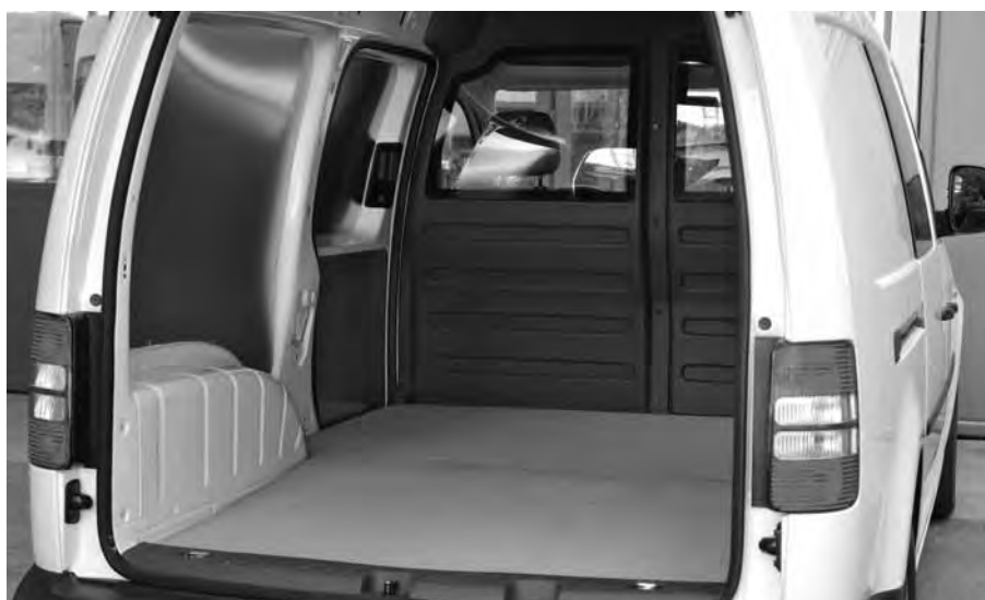
Revêtement du plancher et des parois latérales
