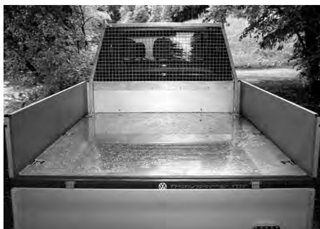
Revêtement du plancher en tôle d'aluminium, surface lisse en haut
