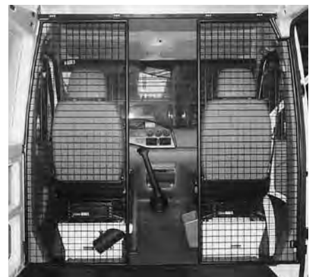
Paroi de séparation B avec passage
