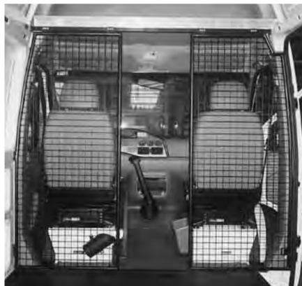
Paroi de séparation B avec passage
