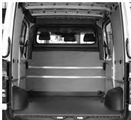
Renforcement de la paroi de séparation en bois contre-plaqué
